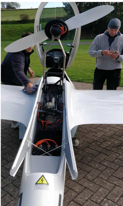
Einblick in das RES von Schleicher ("ME")
