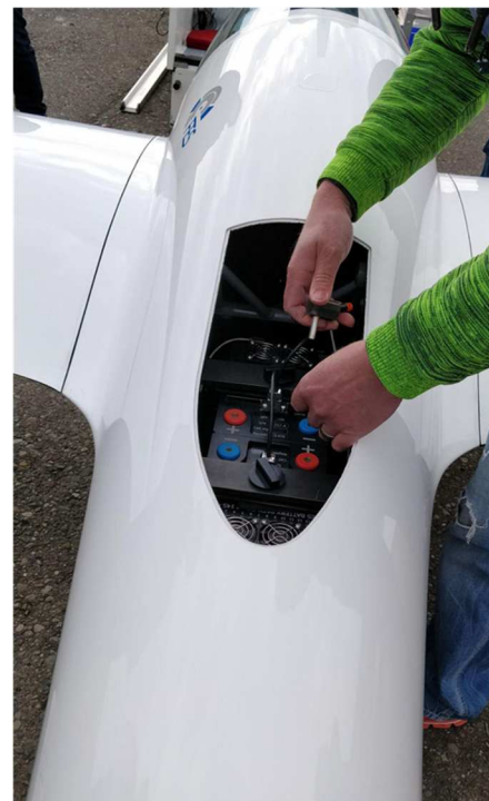
Das FES Batterie System, eingebaut im Discus 2
